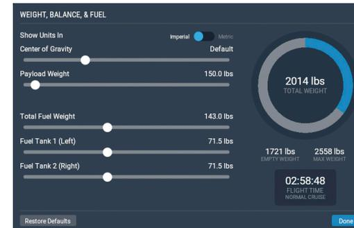
Figure 6.3: Masse, centrage, et carburant pour le Cessna 172 par défaut
