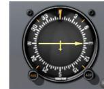
Figure 7.1 L'ADF a bord du Cessna 172
