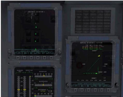
Figure 8.3 L'affichage de la course verticale et horizontale sur les écrans du Space Shuttle
