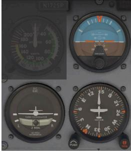
Figure 7.4 : Les trois instruments gyroscopiques primaires du Cessna 172
